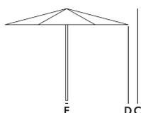
**Details Stamm:** Esche massiv und Naben Birke massiv, mehrlagig wasserfest verleimt, oberflächenimprägniert; **Streben:** Esche massiv, oberflächenimprägniert; **Edelstahlverbindungen;** Kernlederriemen; **Flaschenzugelemente** aus Messing bzw. Messing veredelt; **Bespannung:** Acryltuch
