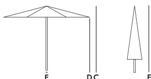
**Details Stamm und Naben:** Teak massiv, mehrlagig wasserfest verleimt, oberflächenimprägniert; **Streben:** Teak massiv, oberflächenimprägniert; **Edelstahlverbindungen;** **Kernlederriemen;** **Flaschenzugelemente** aus Messing bzw. Messing veredelt; **Bespannung:** Acryltuch
