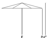
**Details** Stamm: Edelstahl AISI 304; Naben: Teak massiv, mehrlagig wasserfest verleimt, oberflächenimprägniert mit Edelstahlkranz;
